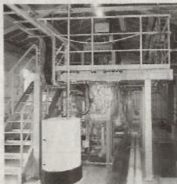
定置型の水素製造装置はCO 2 が発生せず効率も高い
