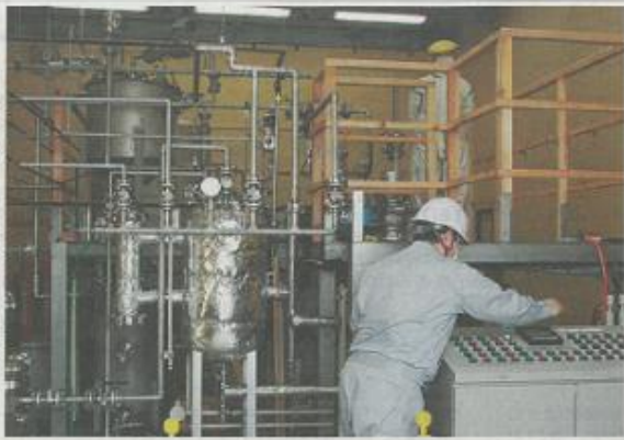
アルミ合金の削り粉から水素を連続的に生成する装置。富山県富山市のアルハイテックで
