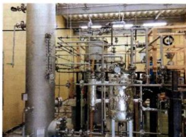
アルミ合金から水素を製造するための実証装置
