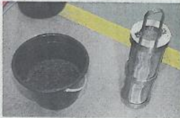
水素の原料となるアルミ合金の削り粉と、それを入れる専用のかご
