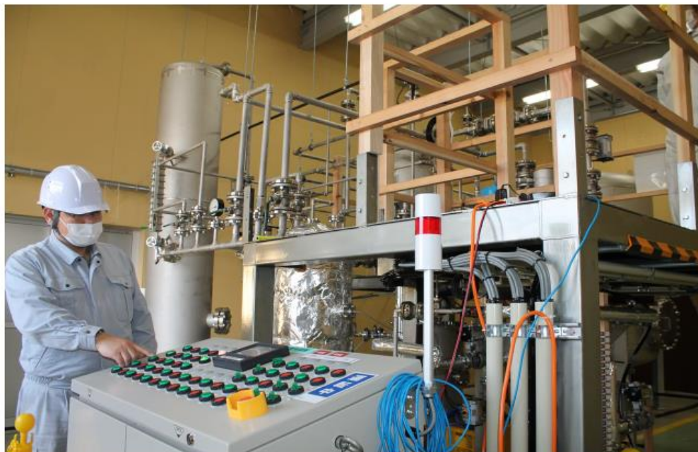
トヨタ自動車のエンジン工場を出たアルミの削り粉を使い、水素を製造する（富山県高岡市のアルハイテック本社）
