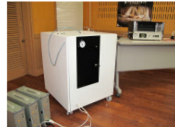
アルハイテックが開発したアルミから水素を発生させる「工小僧」
