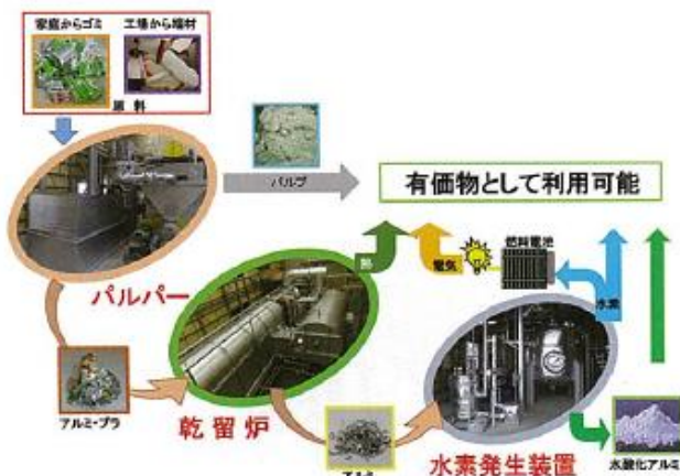
アルミ付き廃棄物から資源・エネルギーを取り出すシステム
