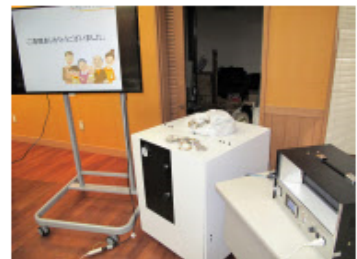
鍋用固形燃料の廃アルミを使って水素を発生させた（南砺市のよいとこ井波）
